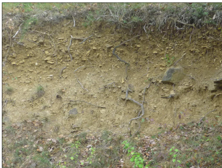
Figure 33 : Affleurement permettant d'observer les éléments anguleux (de taille centimétrique à décimétrique) d'un tablier d'éboulis, en pied d'un petit escarpement entre Pradalas et Borio [Source : IMS RN ]
