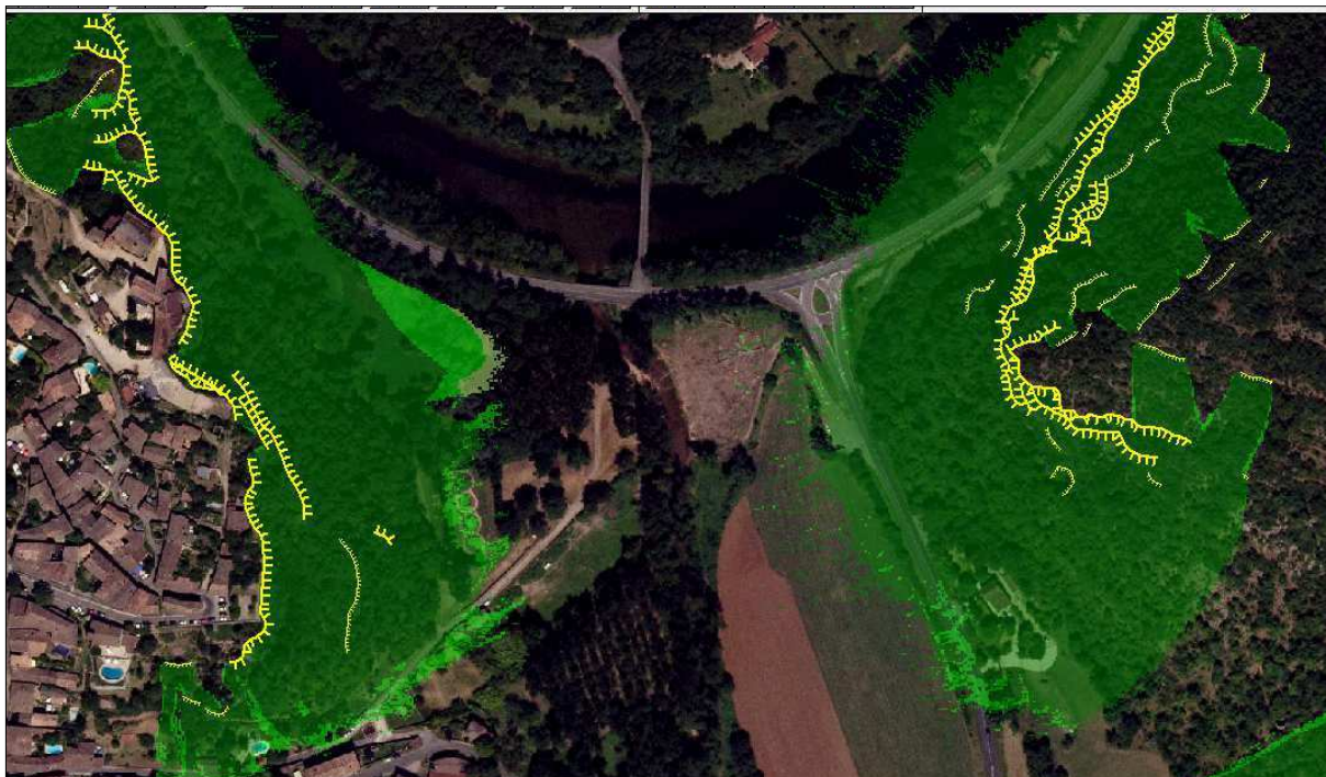
Figure 44 : Extrait du croisement brute entre l'énergie et la probabilité d'atteinte issues de la modélisation trajectographique [Source : IMS RN ]
